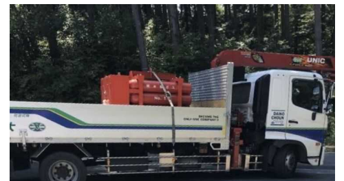
カードルは搭載型トラッククレーンに積み込まれ需要地へ
