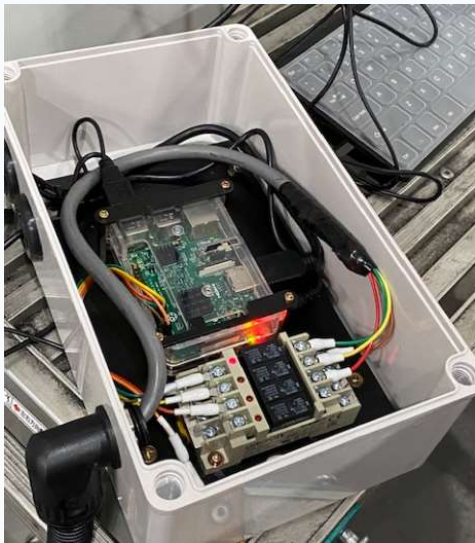
マシニングに実装した Raspberrypi
